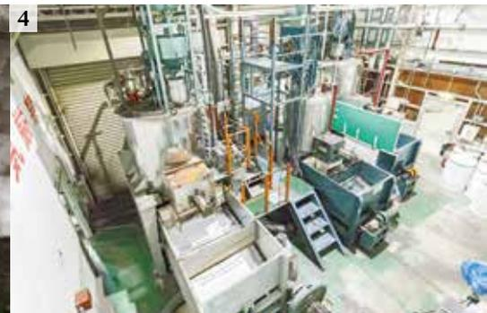
1.工場内部を見学／2.3.発泡スチロールの原料になるポリスチレンビーズ／4.発泡機。高圧蒸気により発泡する／5.シリコンウェハ用容器は温度調整により寸法を安定させる／6.使用済みの発泡スチロールはインゴットにしてリサイクルされる／7.自動車向け部材の用途を濱社長が説明／8.企業メッセージ
